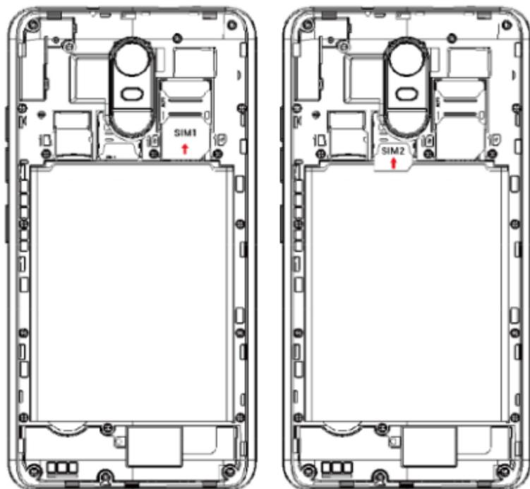
Por favor introduzca la tarjeta SIM de acuerdo a la marca en el teléfono. Asegúrese que la esquina con el corte de la tarjeta SIM y los contactos metálicos vean hacia la dirección correcta. Deslice la tarjeta SIM dentro de la ranura hasta que no pueda moverla más.
